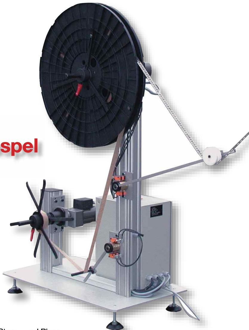
Für den Einsatz an Montage-, Stanz - und Biegeautomaten sind die Haspeln dank ihrer Steuerung und der Möglichkeit der Kommunikation mit der Automatensteuerung besonders geeignet.
